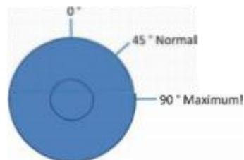
提示：为防止过度拧紧造成 Viper 接头损坏，将 Viper 接头连接到螺纹时，第一次感受到阻力标记为 0°位置，顺时针旋转螺母在 0-45°之间，通常情况均可正常工作。如需进一步拧紧，切勿将螺母转过 90°位置。
